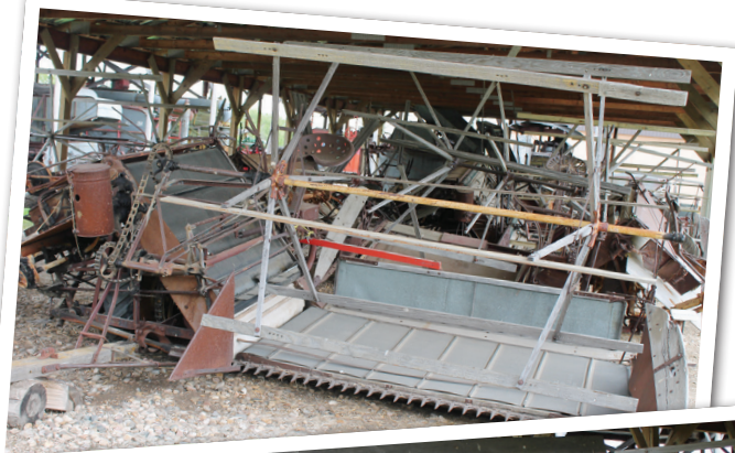
Batteuse : Grosse machine servant à séparer les grains du reste de l'épi de blé. Les premières batteuses étaient en bois, puis en métal. La batteuse était immobile; on y apportait les boisseaux de blé.
