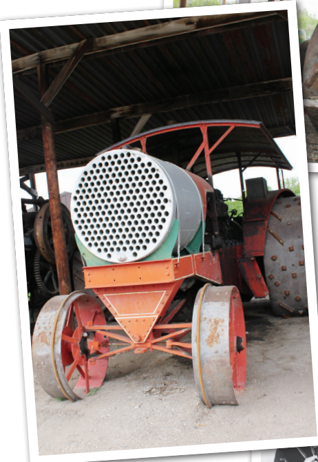
Tracteur : Le tracteur fonctionne au charbon ou à l'essence et remplace le cheval pour tirer la machinerie agricole. Les premiers tracteurs étaient énormes, lourds et très lents. Ils ont ensuite été améliorés et remplacés par des tracteurs plus petits, plus légers et très rapides.
