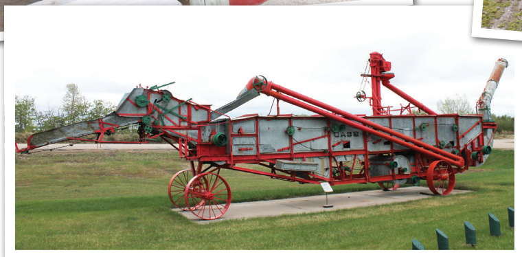
Batteuse : Grosse machine servant à séparer les grains du reste de l'épi de blé. Les premières batteuses étaient en bois, puis en métal. La batteuse était immobile; on y apportait les boisseaux de blé.
